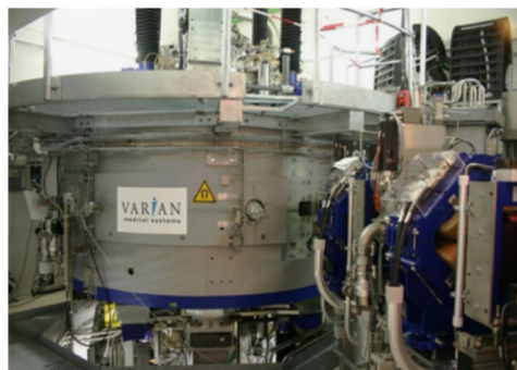
Рис. 11 Общий вид спирального циклотрона со сверхпроводящими магнитами
