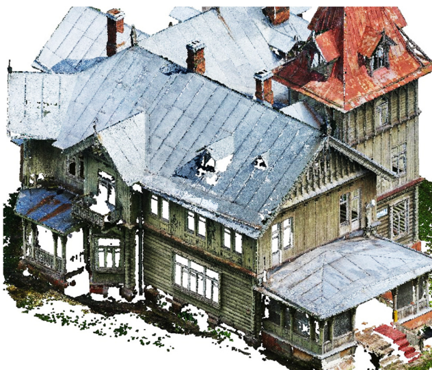
Рисунок 1 – Дача Бенуа, деревянный загородный дом. Облако точек, выполненное по материалам цифровой аэрофотосъёмки
