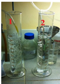
Фото №2. Отдувка аммиака из проб сточных вод. 1-стоки кадмирования, 2-стоки кадмирования+кислотно-щелочные.
