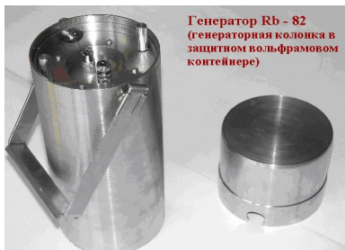
Рис. 13 Схема установки стронций-рубидиевого генератора
