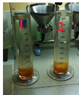
Фото 1. Реагентное отстаивание проб сточных вод. 1-стоки кадмирования, 2-стоки кадмирования+ кислотно-щелочные.
