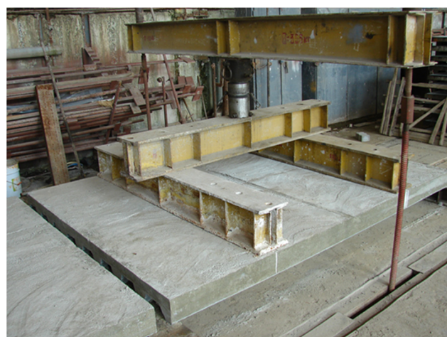
Рисунок 4 – Общий вид экспериментальной установки (натурного стенда) для исследований образца по однопролетной схеме
