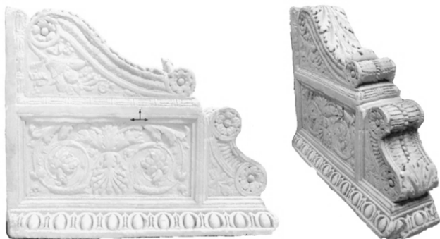
Рисунок 2 – Модель кронштейна, полученное с использованием методов наземного лазерного сканирования и цифровой фотограмметрии
